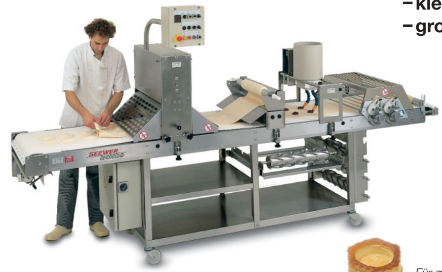
Der automatische Teigbandpositionierer bringt den Teig in eine im voraus definierte, ideale Position zu den Schneidewellen.
